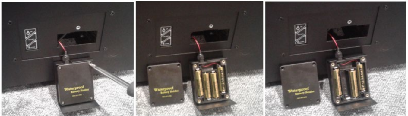
Fig. 10 - Bytte batterier i beholderen
